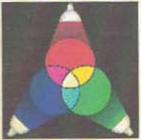
Sistema aditivo de color donde la suma de ellos da el color blanco
