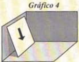
Cuando el papel está en dirección de su hilo, se mantiene firme.
