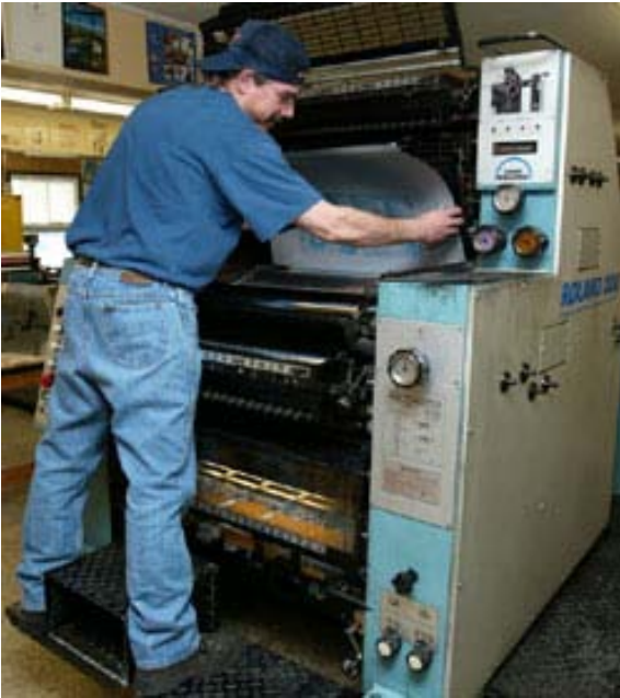
Ubicación de la placa en el cilindro Portaplancha en la Prensa.
