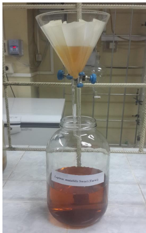
Figura 4. Filtración del Extracto acuoso de Lupinus mutabilis Sweet – sin cascara Fuente: IIFB – UMSA
