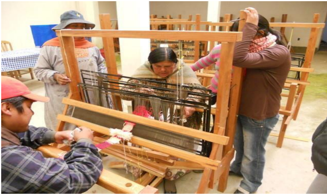
Telar de madera, armado el telar vertical para trabajar las prendas con el técnico.
