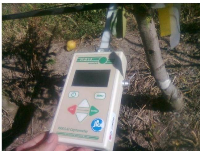
**Figura 16.**Ceptometro (Decagom Devices Inc) instrumento para determinar la intersección de luz.
