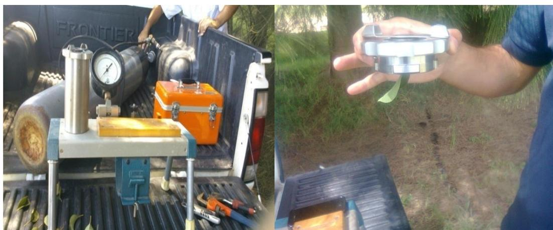
**Figura 15.** Cámara de presión para determinar el estado hídrico de la hoja
