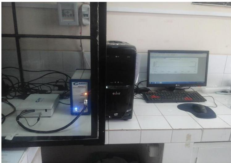
**Figura 5.- Galvanostato - potenciostato Gamry reference 600.**
