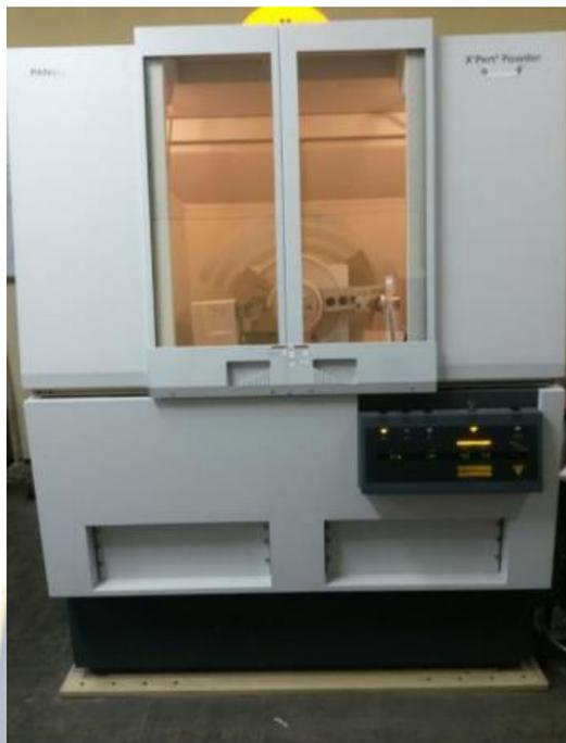
*Figura 4.- Equipo de difracción de rayos X PANalytical Philips, IGEMA-UMSA.*
