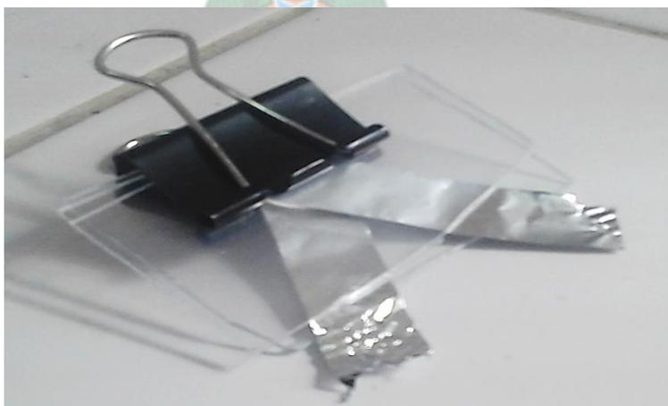
**Figura 6.- Porta muestras para la medición de impedancia (EIS)[20].**
