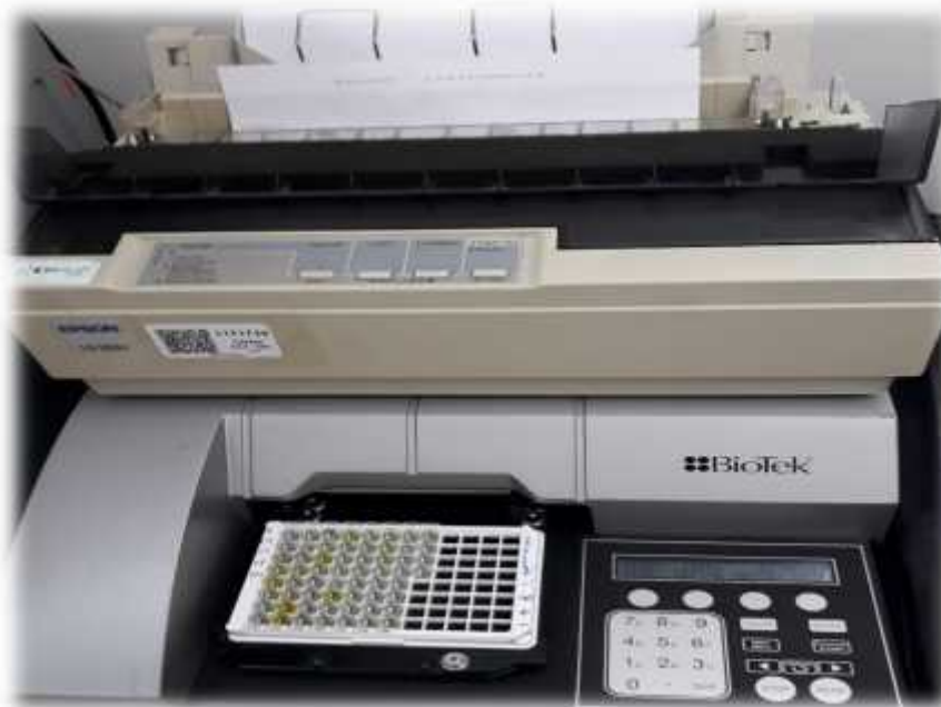
Lectura de la placa de ELISA con los resultados en el espectrofotómetro a 450 nm
