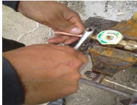
Figura 4.38 Sujeción del visor a una prensa para su unión por soldadura (Fuente: Elaboración Propia)
