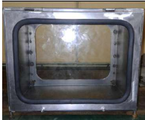
Figura 4.13 Recinto del evaporador (Fuente: Elaboración Propia)
