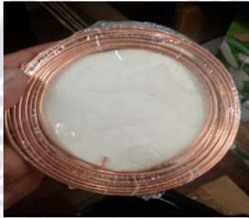
Figura 3.17 Control de flujo seleccionado (tubo capilar) (Fuente: Elaboración Propia)
