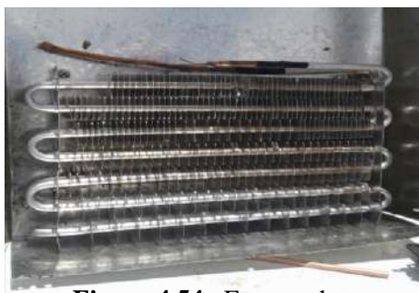
Figura 4.54 Evaporador (Fuente: Elaboración Propia)
