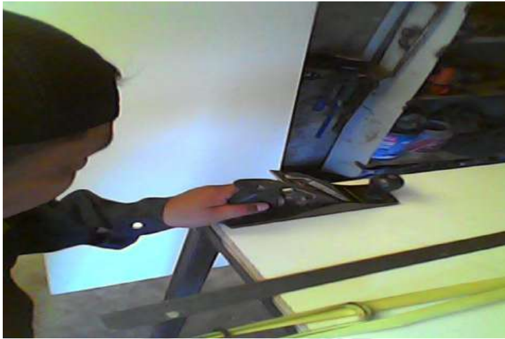
Figura 4.9 Cepillado bordes de la madera melaminica (Fuente: Elaboración Propia)
