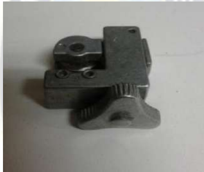
Figura 4.22 Elemento de corte de cañerías de cobre (Fuente: Elaboración Propia)
