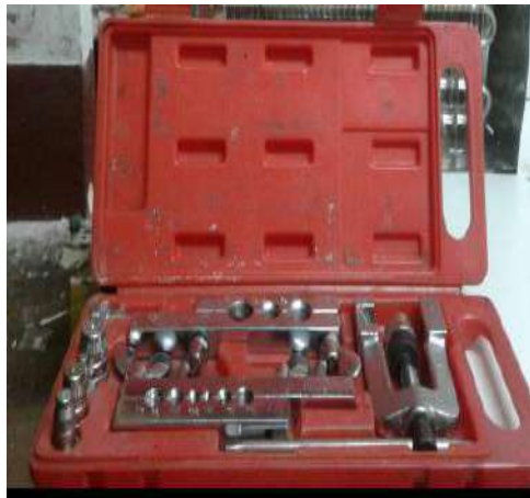
Figura 4.18 Juego de avellanado de tuberías (Fuente: Elaboración Propia)
