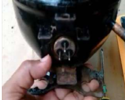
Figura 4.56 Bornes de conexión del compresor (Fuente: Elaboración Propia)
