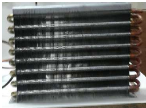
Figura 4.30 Montaje del condensador (Fuente: Elaboración Propia)
