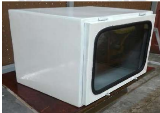
Figura 4.14 Recinto concluido del evaporador (Fuente: Elaboración Propia)
