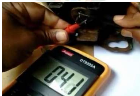
Figura 4.58 Medición de los bobinados (Fuente: Elaboración Propia)
