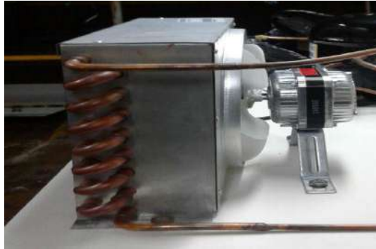
Figura 4.36 Montaje del forzador de aire (ventilador) (Fuente: Elaboración Propia)
