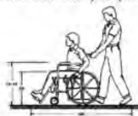
Figura 8: Dimensiones silla de ruedas y acompañante (vista lateral)
