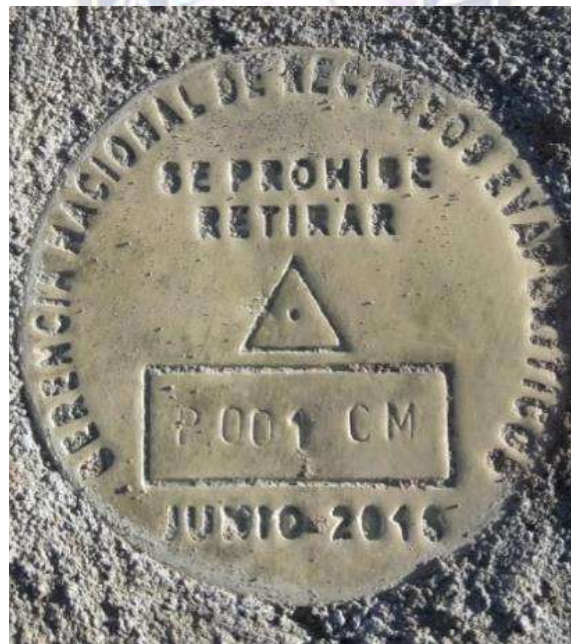
Fotografía N° 6 Bulón de bronce P-001 CM Fuente: Propia
