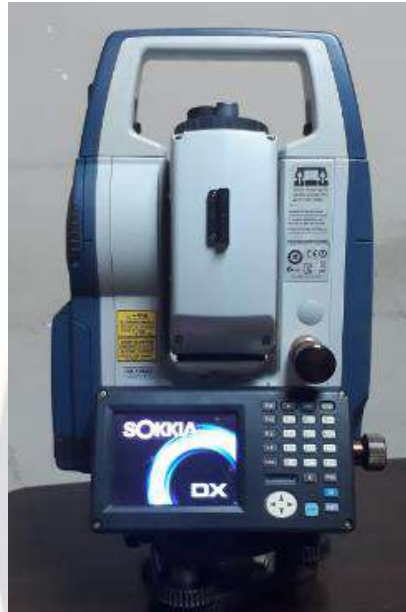
Fotografía N° 3 Equipo ET. Sokkia DX 105 AC Fuente: Propia
