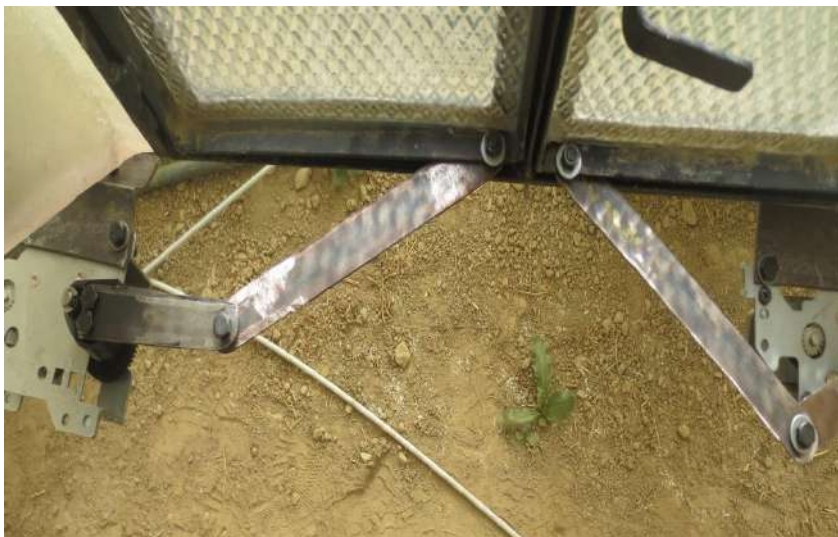
Foto 21. Vista superior del mecanismo Biela-manivela ventanas laterales.
