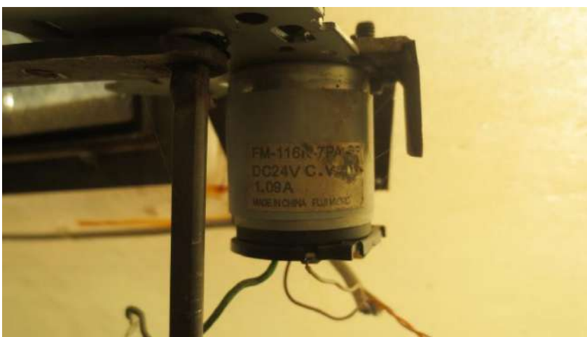
Foto 22. Motor de las ventanas laterales.
