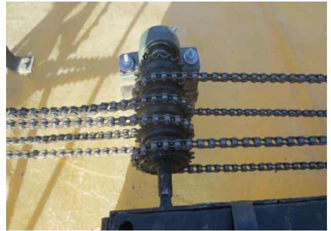
Foto 18. Eje central de transmisión de movimiento.
