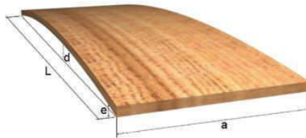
Figura 2 - 28: Deformación de la madera llamado arqueadura
