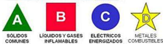
Figura 5 - 32: Clasificación de uso de extinguidores
