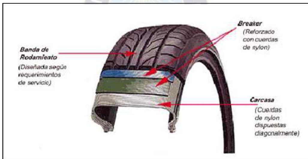
Grafico 2.2. Estructura del Neumático Radial
