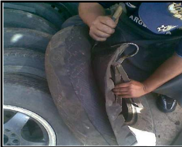
“Apertura” de una llanta
