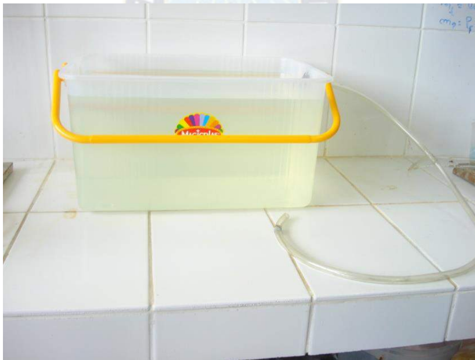
FOTOGRAFIA 3-2: SISTEMA DE LIXIVIACIÓN CON RECIRCULACIÓN
