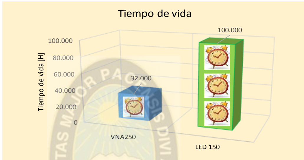
FIGURA 6-6. Tiempo de vida de luminaria Vapor de NA 250 y LED 150 W.
