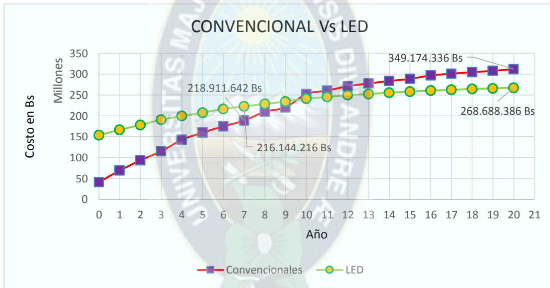
FIGURA 7-13. Comparación económica de luminarias Convencionales y LED.
