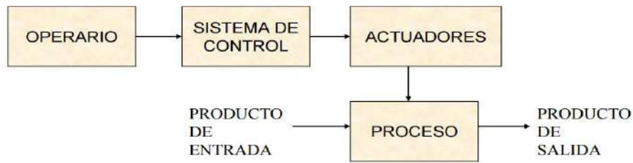
Figura 2.9 Control de lazo abierto (Fuente: sites.google.com/site/tecnoindus1/sistemas-de-control)
