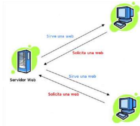
Figura 2.5 Funcionamiento Servidor Web (Fuente: gorkamu.com/2017/06/entendiendo-protocolo-http/)
