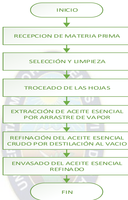
Diagrama 4 PROCESO PRODUCTIVO DE LA OBTENCIÓN DE ACEITE ESENCIAL REFINADO DE MORINGA
