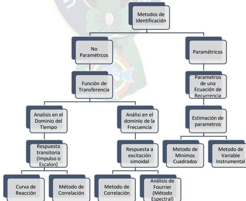
Figura 4.2 - FUNCIÓN DE TRANSFERENCIA: Métodos Identificación de modelos de sistema de control
