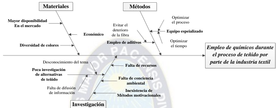
DIAGRAMA 1 - 1: Diagrama de Ishikawa para el empleo de químicos durante el proceso de teñido por parte de la industria textil.
