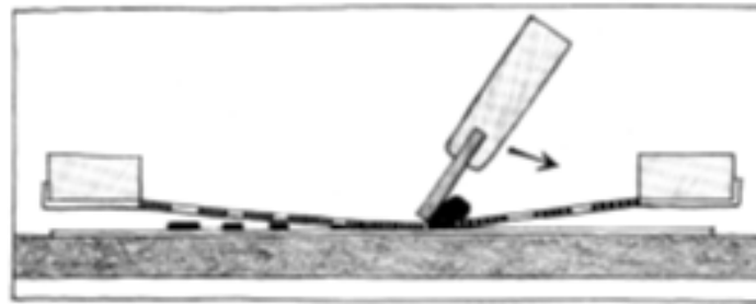
FIGURA 1.3 PASO DE PINTURA EN MALLA
