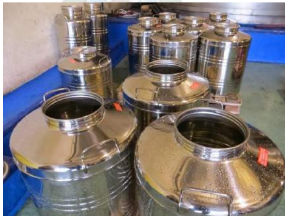
Ilustración 14 Macerado en Contenedores Metálicos
