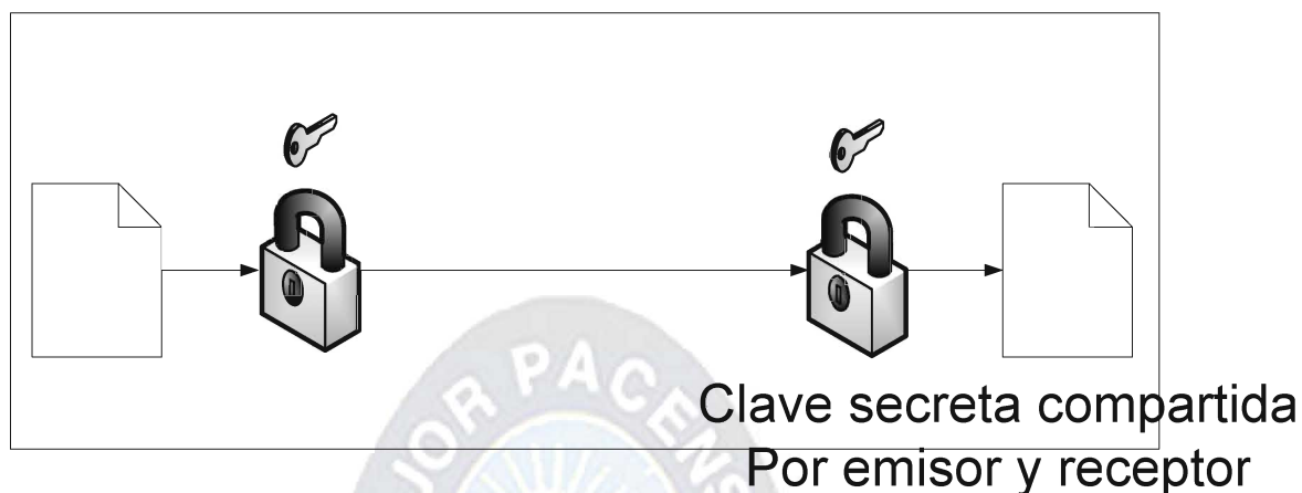
Figura 2.6.1: Modelo simplificado del cifrado convencional o simétrico
