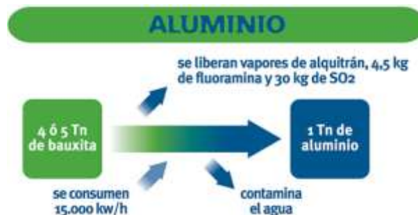
Figura 4.19. Reciclaje del aluminio.
