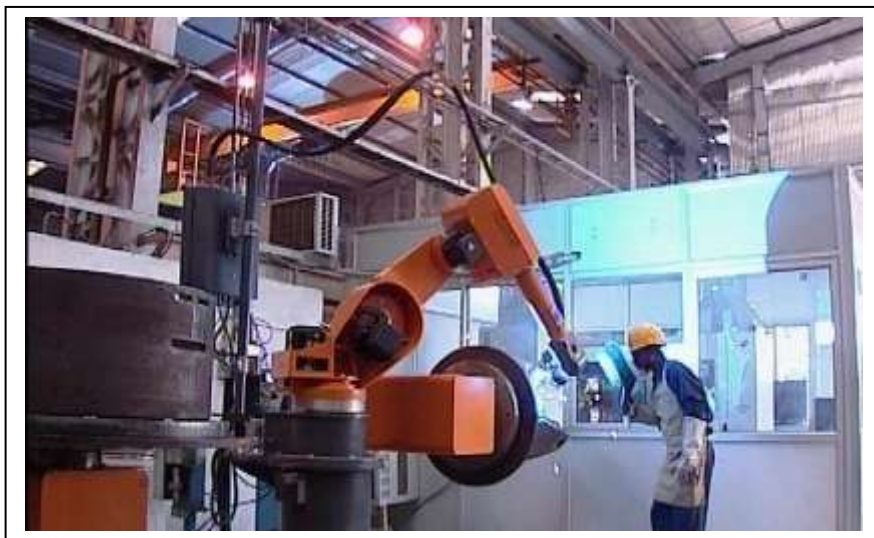
Figura 2.3 Brazo robótico especializado en soldadura de plasma CLOSS Schweissttechnik utilizado por la empresa Apex Auto en Estados Unidos 82 .
