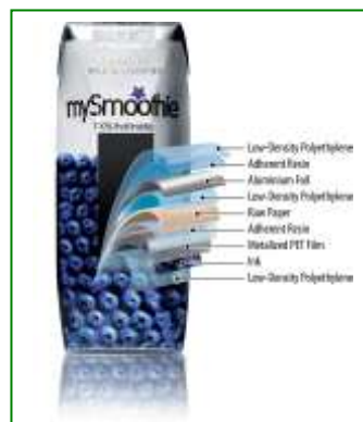
Figura 4.17 Composición del producto Tetra Brik. Fuente: http://bestbrandsmarketing.com
