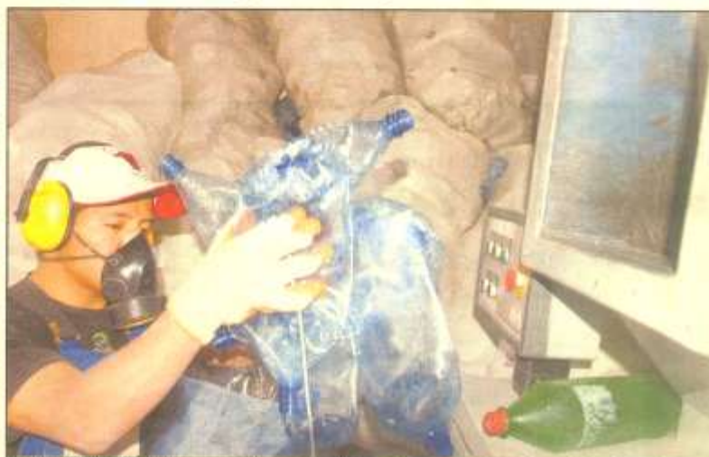
A LA TRITURADORA • Juan Carlos Mamani introduce las botellas Pet aplastadas en la única máquina que reducirá el plástico en escamas: 130 kilos se procesan por cada hora.
