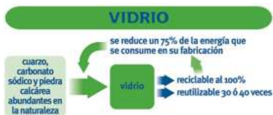
Figura 4.18. Reciclaje del vidrio.
