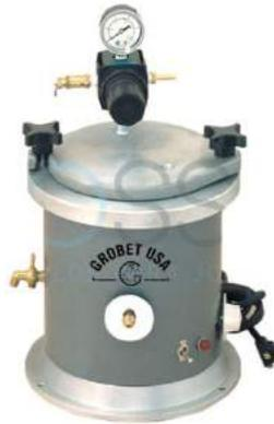
*Ilustración 14: Máquina inyectora de cera tomado de <http://www.rosse.cl>*
