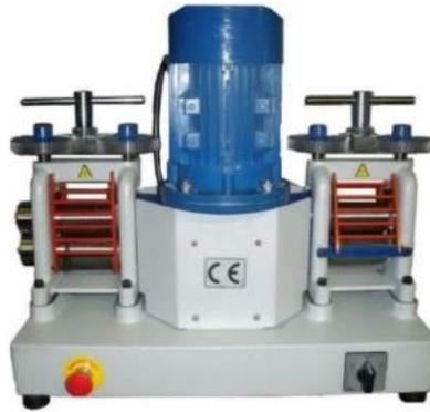
*Ilustración 11: Máquina laminadora eléctrica de dos cabezales, tomado de <http://maquijoy.com>*
