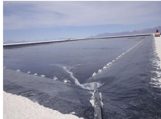
La primera piscina, Halta recibe la salmuera de las capas profundas del Salar de Uyuni
