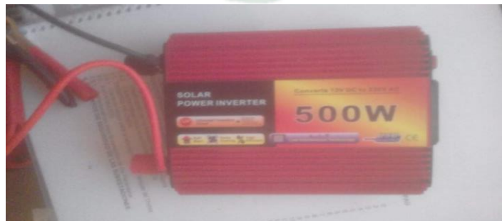
Figura # 8 Inversor Dc A Ac
