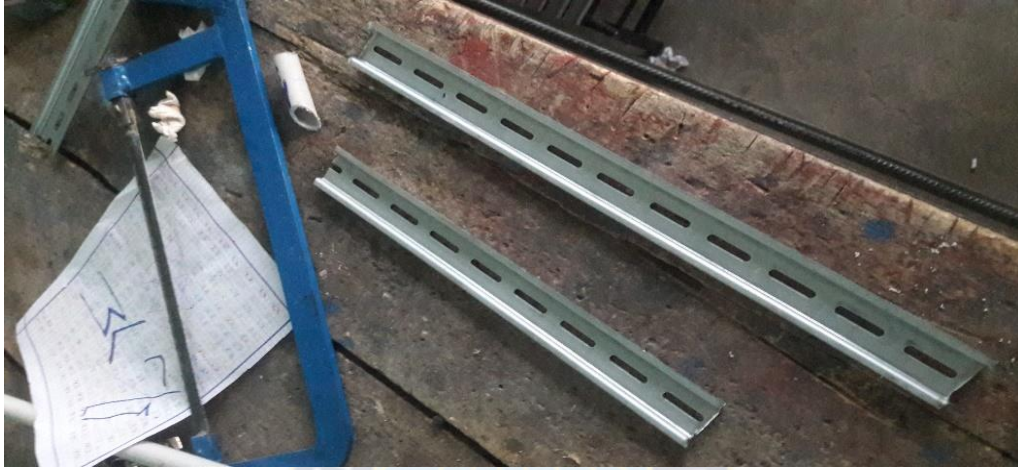
Figura # 12 Corte De Riel Para El Soporte De Los Componentes
