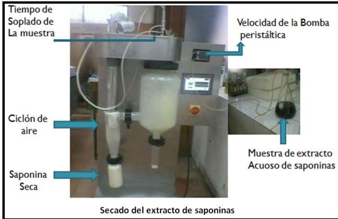
Figura 7. Equipo para el secado por aspersión del extracto acuoso de saponinas de quinua
