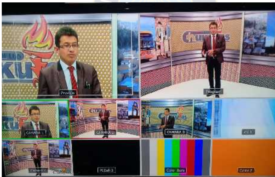
Figura 3.7 televisor subdividas q muestran las cámaras, videos de apoyo y el dvr.
