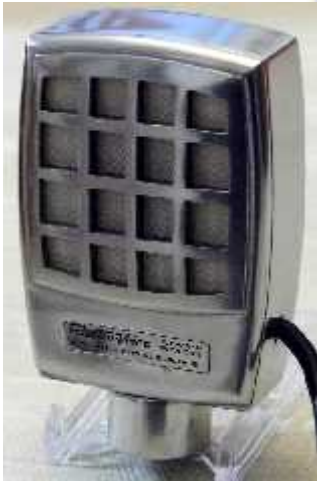
Figura 2.39 Micrófono piezoeléctrico Electro-Voice Century (hacia 1950)
