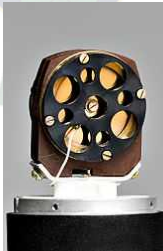
Figura 2.33 Prototipo inicial de un micrófono de condensador
