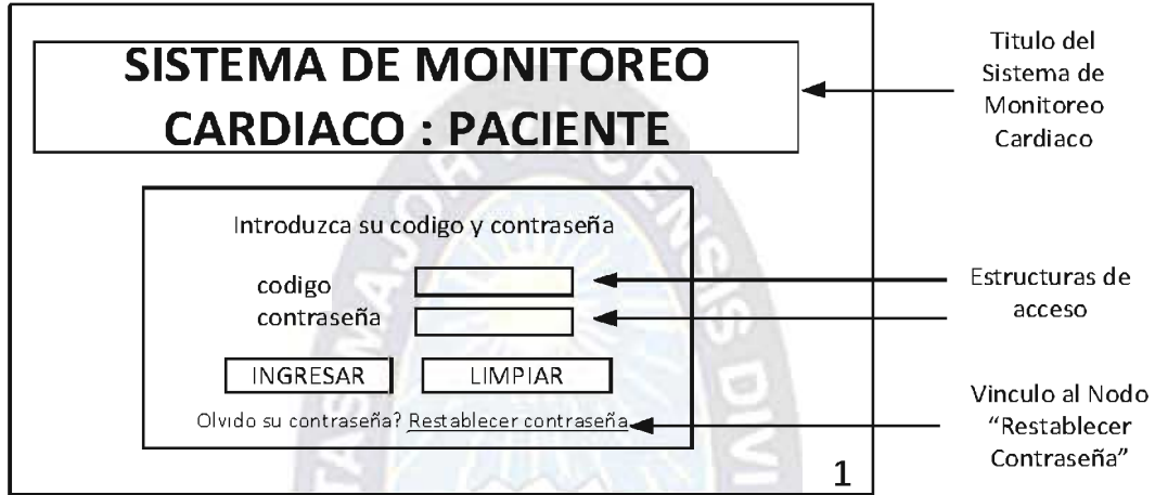
Figura 24. Diagrama del nodo Identificación de Usuario – Login Fuente. Elaboración Propia.
