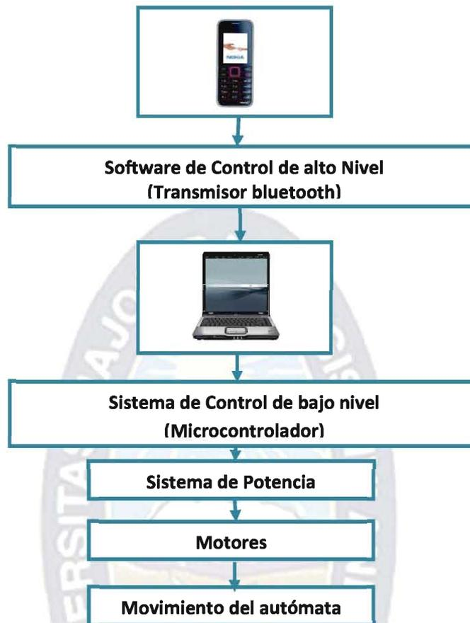
Figura III, 8 Sistema de Control
