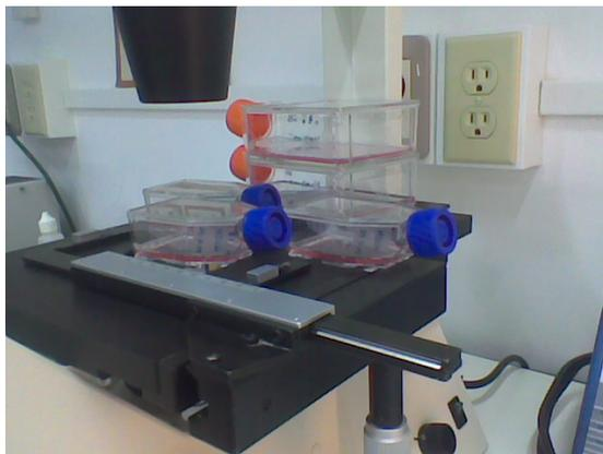
Microscopio invertido donde se observa el estado de las células en cultivo
