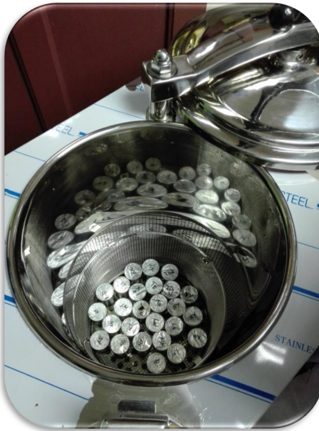
Anexo N°7 Autoclavado de los medios de cultivo
