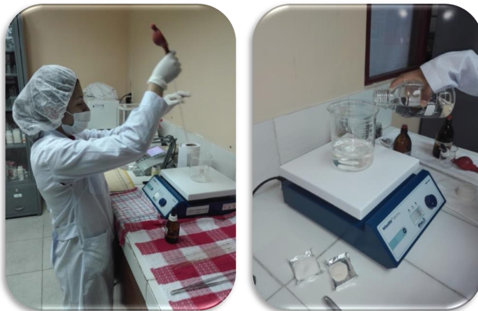
Figura 3. Adición de Reguladores de Crecimiento y Aforado del Medio de cultivo.
