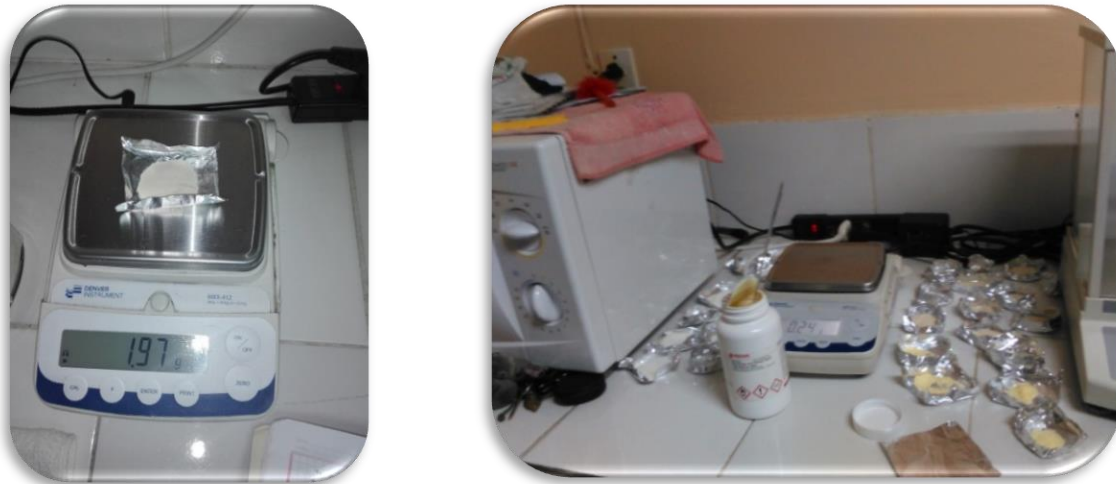
Figura 2. Pesado de los Reactivos que compone el Medio de Cultivo.
