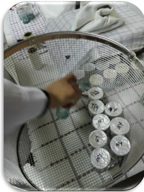
Anexo N°6 Introducción del medio de cultivo al autoclave
