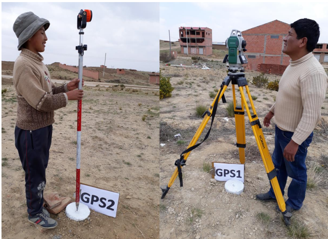
Figura 42: Levantamiento Topográfico con Estación Total Fuente: Elaboración Propia
