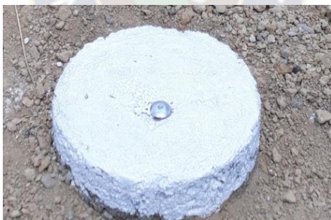
Figura 38: Punto de Control Materializado Fuente: Elaboración Propia
