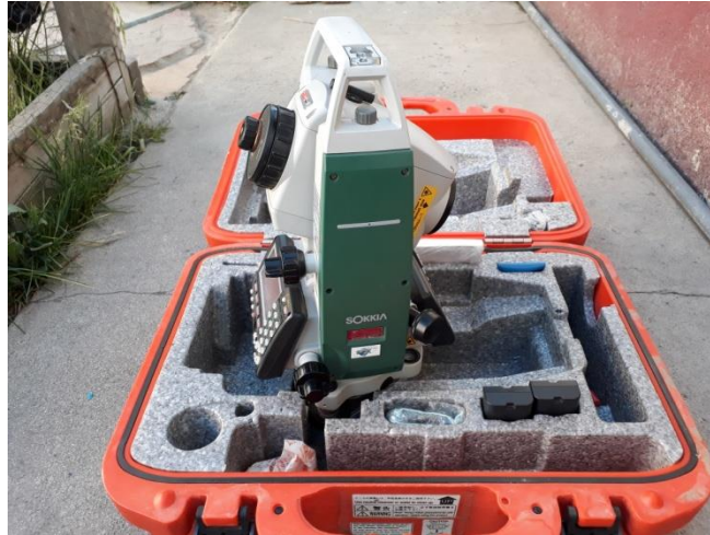
Figura 36: Estación Total marca SOKKIA modelo SET550RX Fuente: Elaboración Propia
