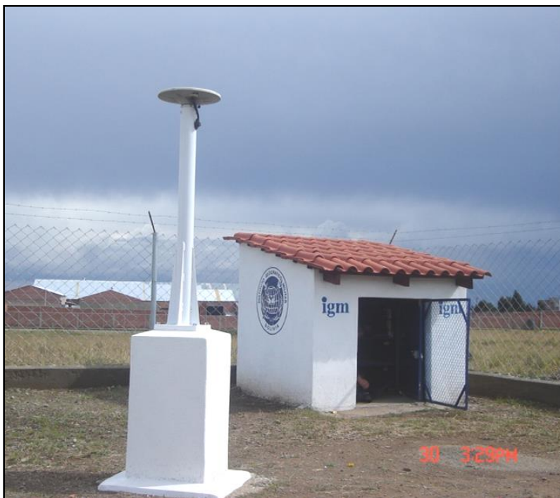
Figura 10: Estación Continúa GPS GNSS LPZB (INGA) Fuente: IGM-Bolivia
