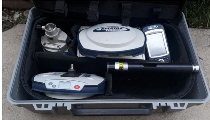
Figura 32: Equipos GPS L1 L2 GNSS RTK marca SPECTRA Precisión SP80 Fuente: Elaboración Propia
