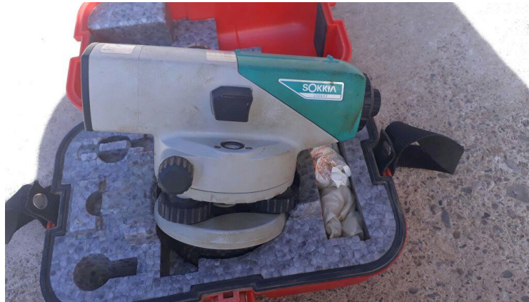
Figura 34: Nivel Automático Marca SOKKIA modelo B40 Fuente: Elaboración Propia
