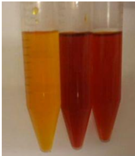
Figura 31. El DNS, de color amarillo en medio básico, se reduce a 3-amino-5-nitrosalicilato, de color rojo ladrillo. Fuente propia.
