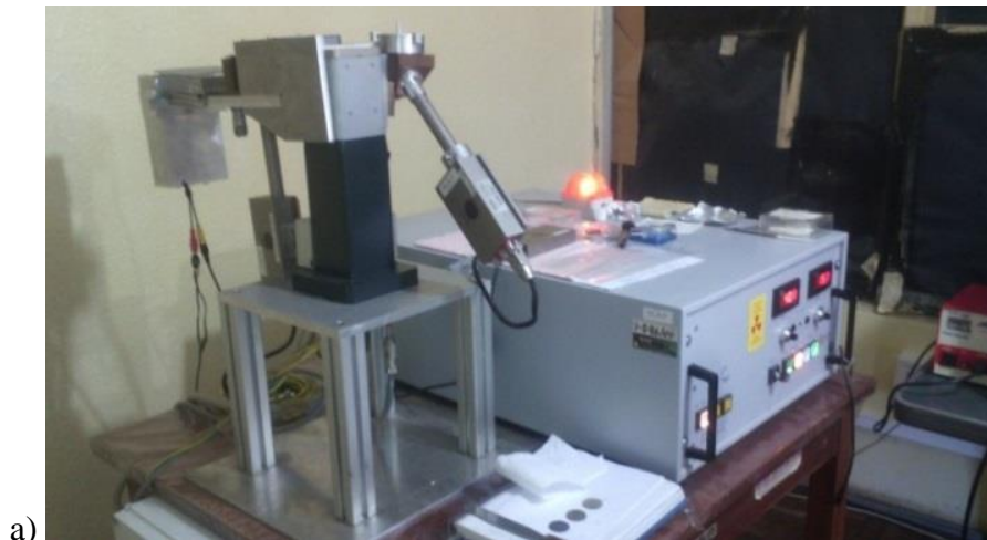
Figura 13. Análisis de Fluorescencia de Rayos X IBTEN en la localidad de Viacha a) Equipo de Fluorescencia de rayos X y b) Cátodo radiación gamma de Molibdeno
