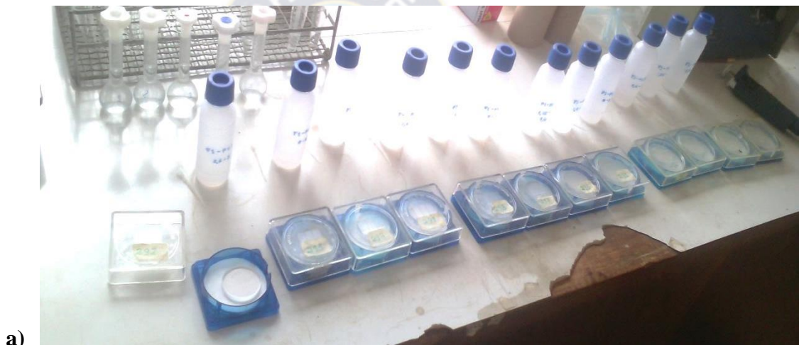
Figura 14. a) Preparado de las muestras en los reflectores b) Muestra centrada en el reflector de cuarzo
