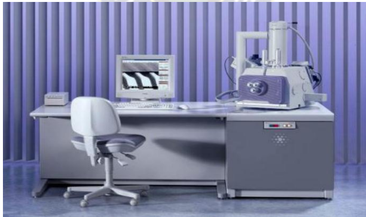
Fig. 18 Equipo de SE. PHILIPS/FEI XL-30 para espectroscopía electrónica de barrido SEM
