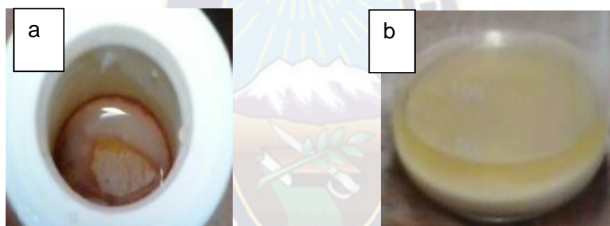
Fig. 27 a) Solución de óxido de titanio M5SS a 1 hora de tratamiento hidrotérmal a 100°C. b) Solución después del segundo envejecimiento de 72 hrs. A 140°C.
