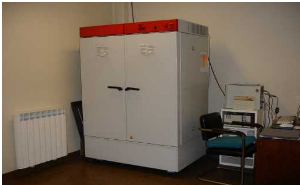
FIGURA Nº 6 CÁMARA PARA ESTUDIOS DE ESTABILIDAD CON CONTROL DE TEMPERATURA, HUMEDAD, Y LAMPARA ULTRA VIOLETA
