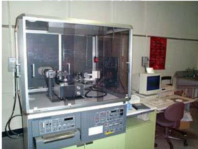
Figura N° 4: Equipo de Difractómetro Rigaku Geigerflex, Laboratorio de Geología–UMSA.
