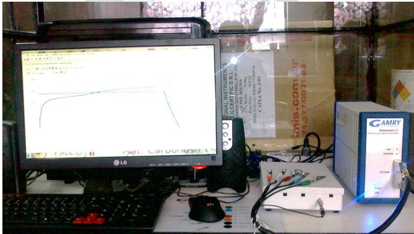
Figura N° 6: Equipo Potenciostato/Galvanostato GAMRY REFERENCE 600
