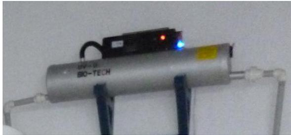
**Figura N°12.** Sistema de luz UV-O<sub>3</sub> en el proceso de purificación de aguas en la empresa ELVIMAR S.R.L.
