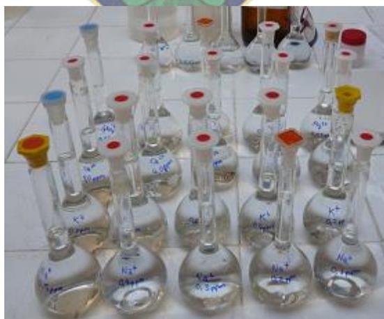
**Figura N°21.** Preparación de soluciones patrón de Sodio, Potasio, Calcio y Magnesio para la construcción de las curvas de calibración respectivas.
