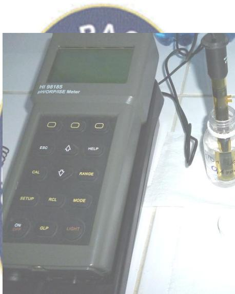
**Figura N°24.** Determinación de cloruros utilizando el electrodo de ión selectivo HANNA Instruments.
