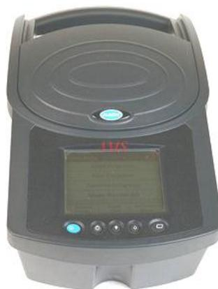
**Figura B.4.** Espectrofotómetro HACH multiparámetros, modelo DR/2400.
