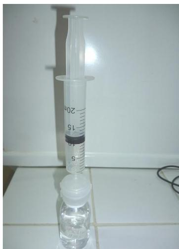
**Figura N°16.** Filtración con una membrana Millipore de 0.45  $\mu\text{m}$ .
