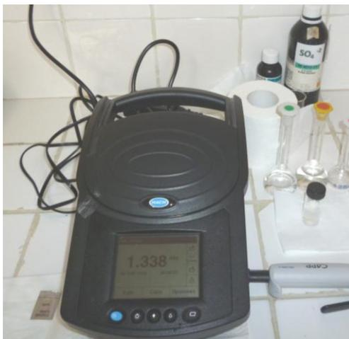
**Figura N°22.** Determinación de Sulfatos con el equipo Multiparámetro HACH.
