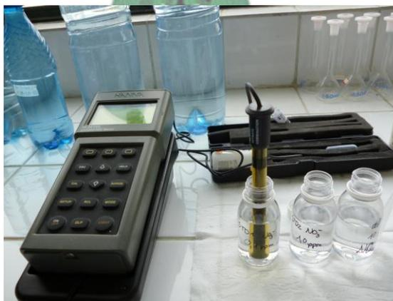
**Figura N°23.** Determinación de Nitratos con electrodo de ión selectivo para nitratos, HANNA Instruments.
