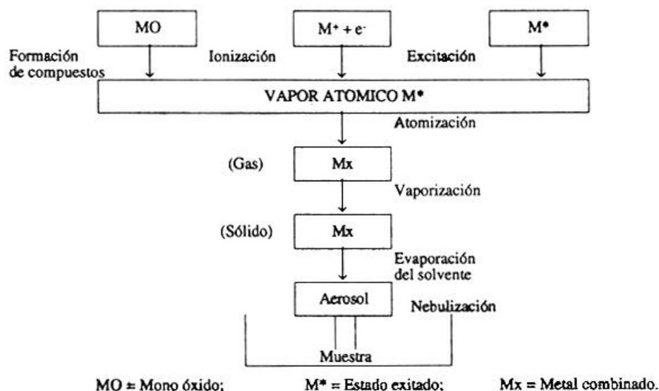
**Figura A.2.** Diagrama del proceso de atomización en una llama.
