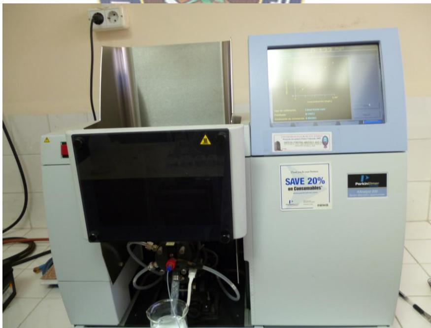
**Figura N°19.** Espectrómetro de Absorción Atómica AAnalyst 200 PerkinElmer Instruments.
