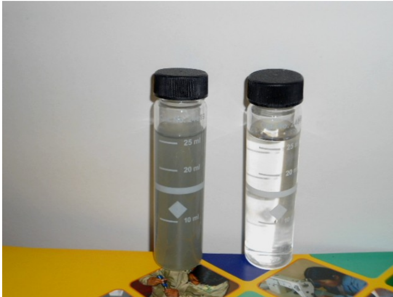
Fotografía N°4: Resultado colorimétrico de análisis de fósforo reactivo
