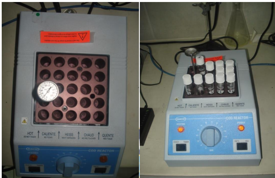
Figura 3.1. Reactor típico para pruebas de DQO en sistema cerrado Fuente: CPTS
