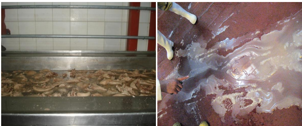
a) Tanque del cocimiento de cueros b) Colágeno vertido y solidificado, por enfriamiento, sobre el piso en la sección de cocidos y ahumados.
