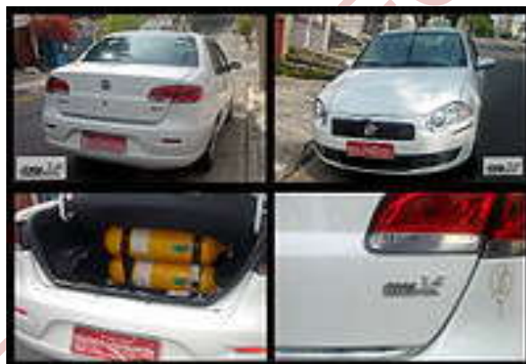
GRÁFICO N° 7 Instalación de GNV
