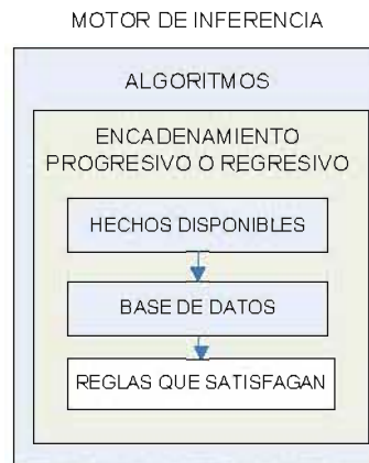
Figura 2.6: Estructura del motor de inferencia Fuente: [Centuria, 2010]
