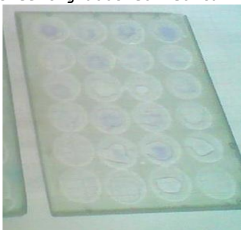
Fotografía 21: Resultados del test de aminofenazona en manchas sometidas a temperaturas de 60 grados centígrados
