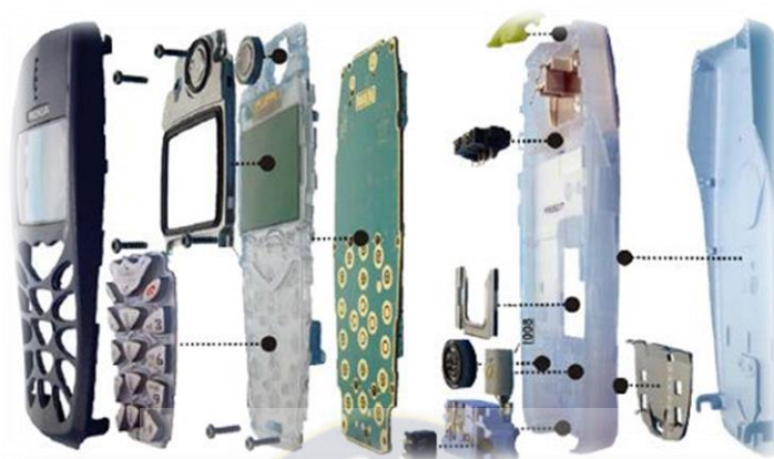
Figura 11. Componentes de un teléfono celular.
