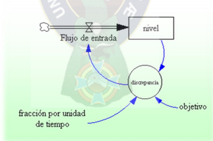
Figura 7. Diagrama de Forrester, se observa interrelación Componentes, Variables de Nivel, Variables de Flujo y Variables Auxiliares.
