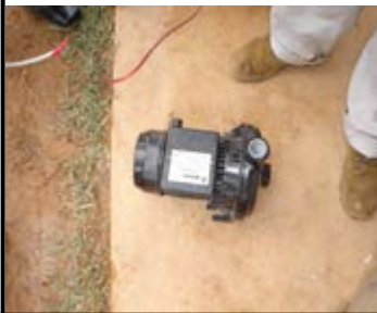
MOTOR PARA BOMBERAR AGUA AL TANQUE ELEVADO
