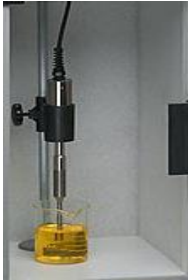
Figura N°3. Proceso de sonicacion de la suspensión bacteriana aislada partir de colonias de E. coli enteroinvasiva que han sido determinadas previamente con un antisuero comercial
