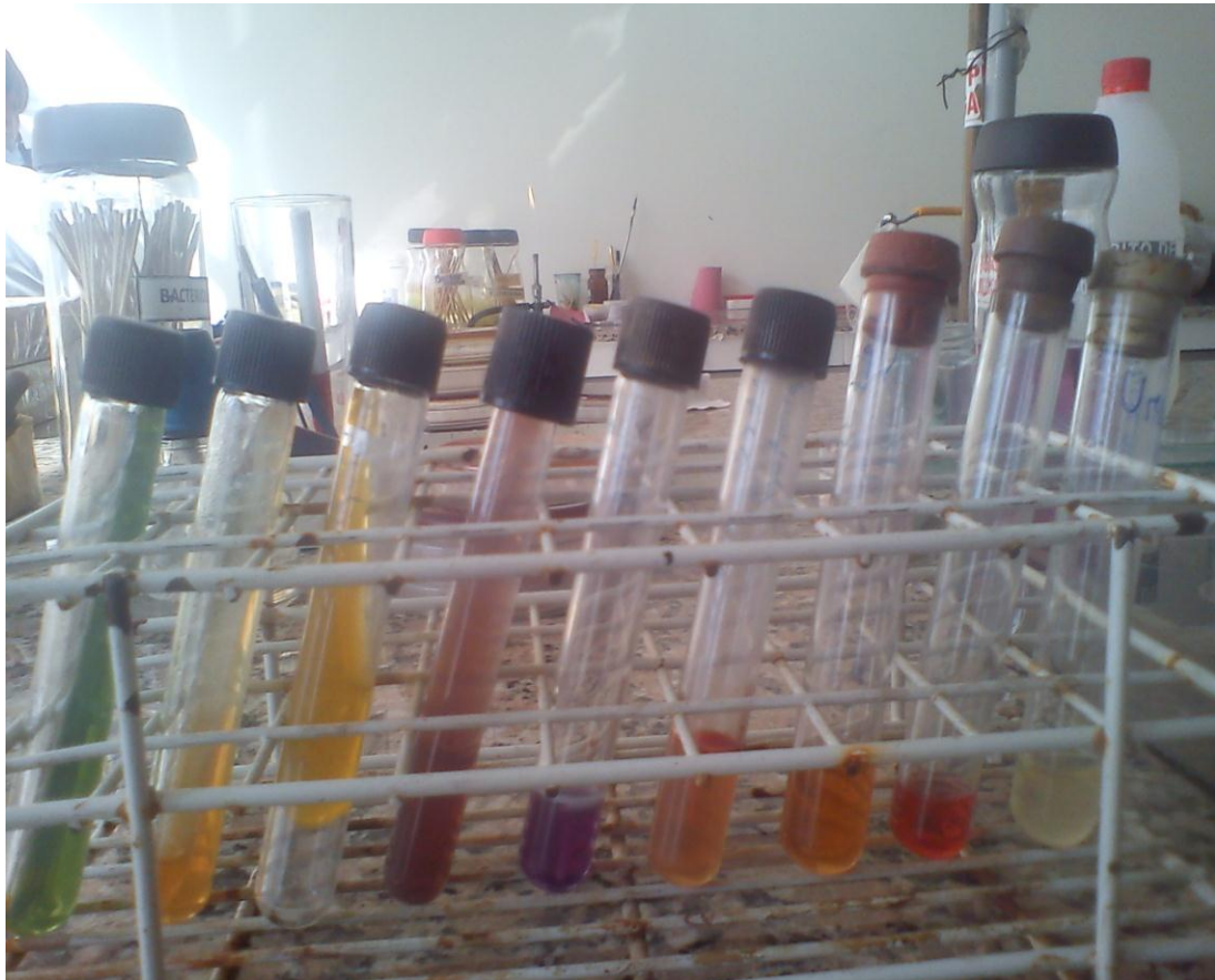
Fig.N°4. Galería de pruebas Bioquímicas que se realizan para identificar una cepa de Escherichia coli , en la fotografía de izq a der se observa el tubo de Citrato, urea, Kligler, Lisina, Mio, Sim con la prueba de Indol positiva, VP, Rojo de Metilo y APP.
