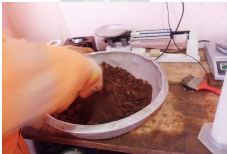
Fotografía N° 28 Mesclado de grava y fina y el agua de 2%
