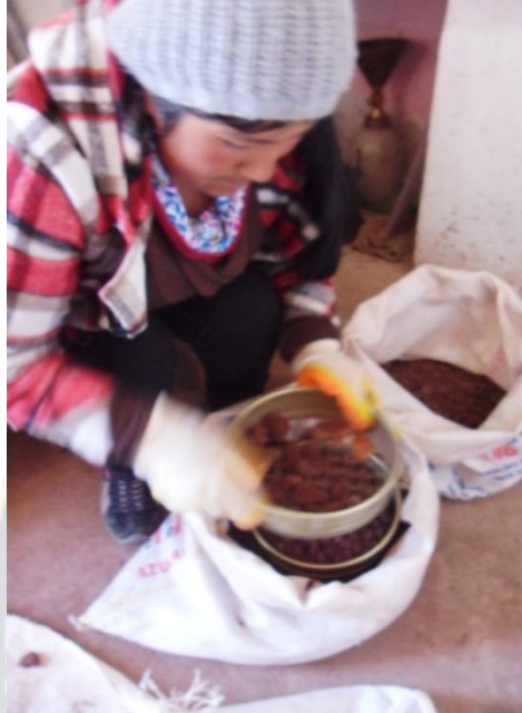
Fotografía: N°27 Cuarteo con los tamices 4” y ¾”
