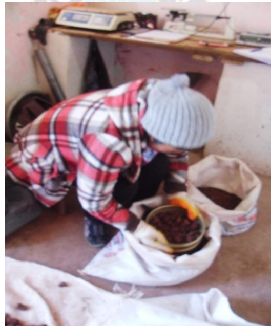
Fotografía: N°26 Cuarteo de la muestra
