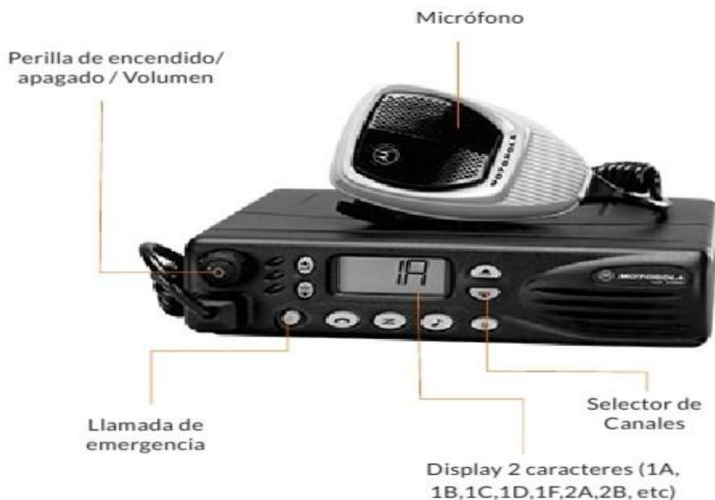
Fig. 2.36 Partes Generales del equipo Motorola LCS2000. Fuente: www.repeater-builder.com
