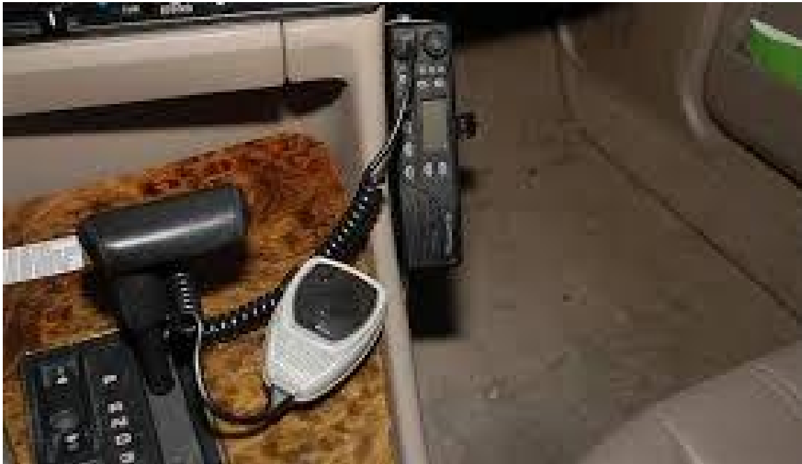
Fig. 3.8 Equipo Motorola Radia Móvil Instalado en unos de los autos del departamento de Transmisiones. Fuente: Foto Propia (Pasantía)
