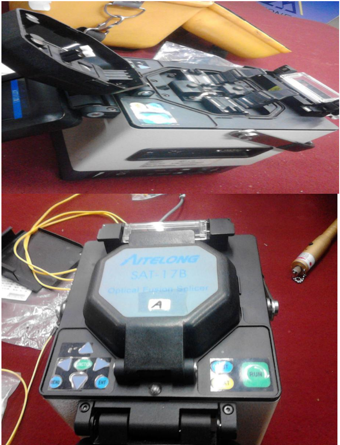
Aparato fusionador de fibra óptica presente en la sección de transmisiones urbanas
