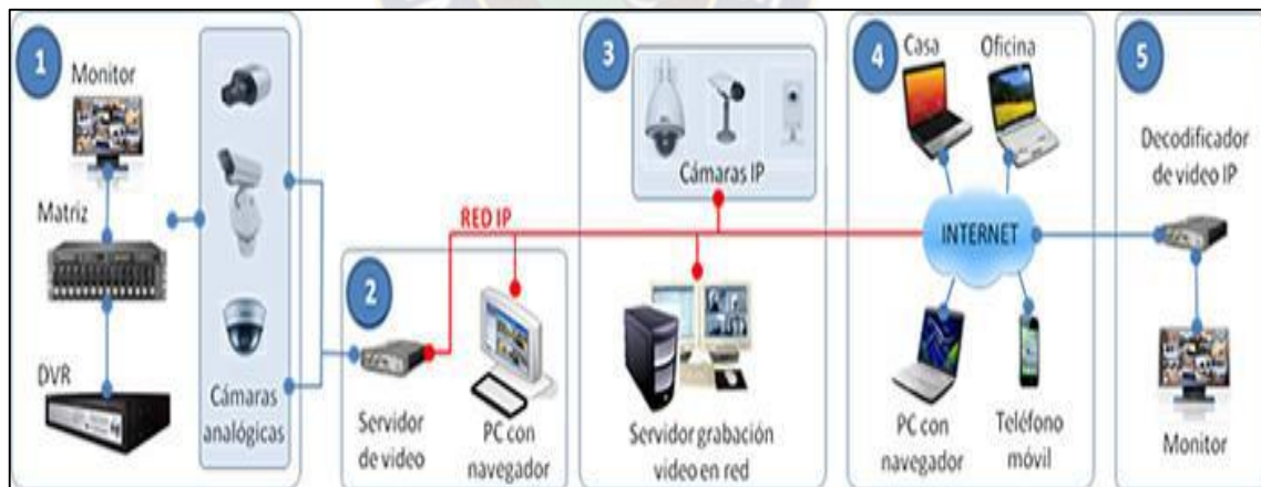
Figura 2.40 Sistema Híbrido de CCTV
