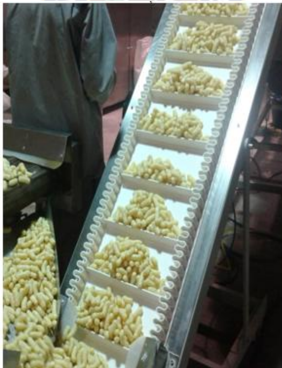
Foto N° 12: Cinta de transporte (ingreso a tambor 1)
