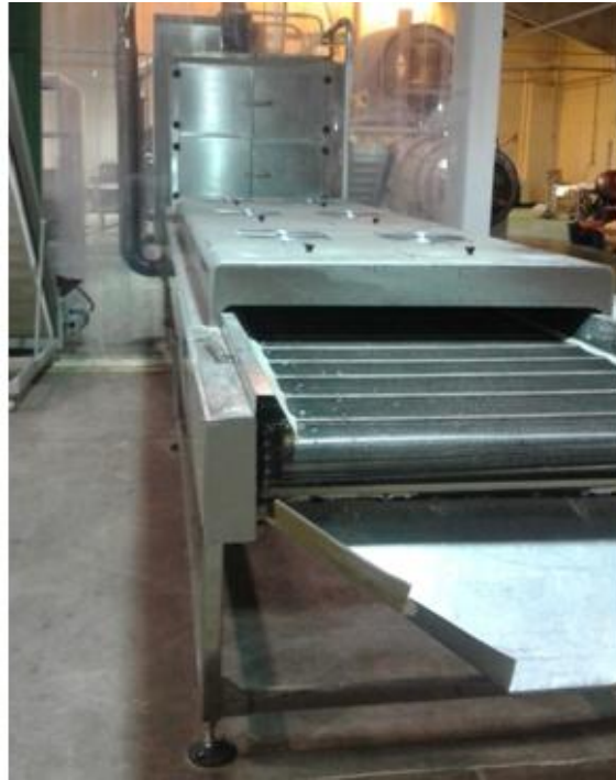
Foto N° 11: Cinta de enfriamiento a la salida del horno
