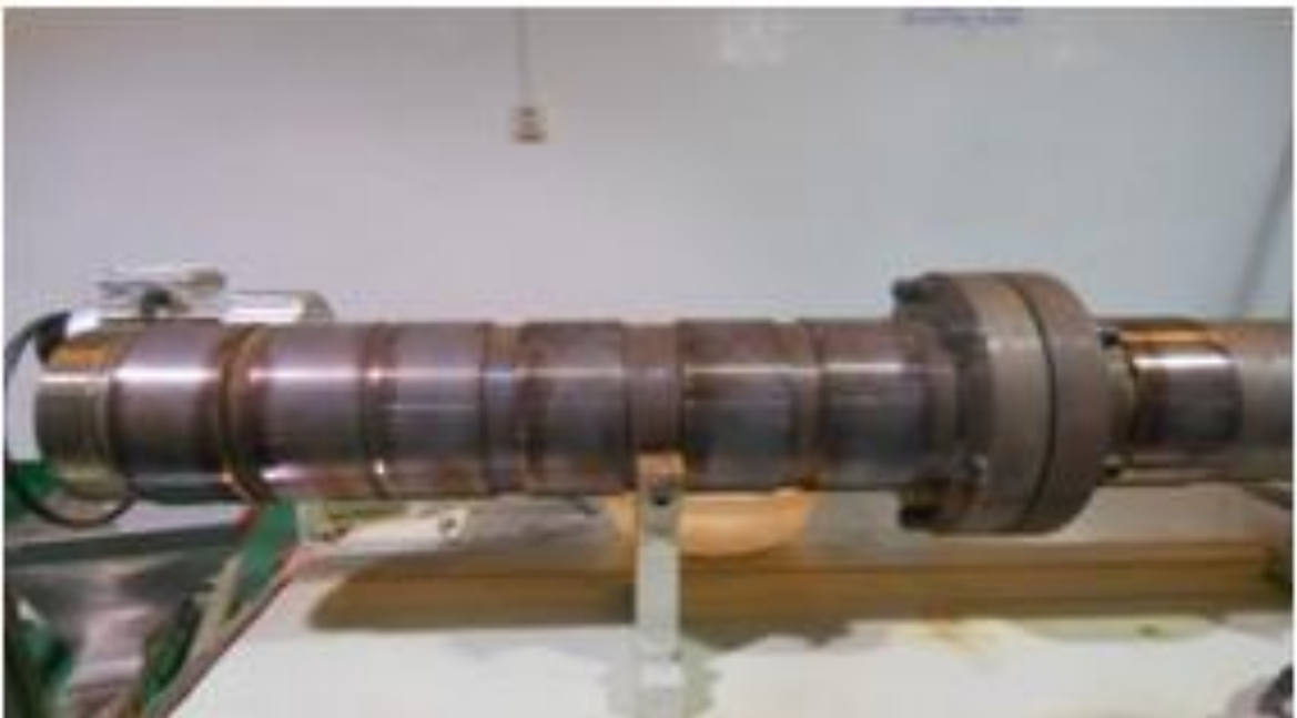
Foto N° 8: Camisa de calefacción y resistencias
